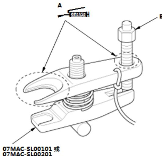
2. 在球节拆卸工具的所示部位 (A) 上涂抹润滑脂。这便于安装工具，并防止损坏压力螺栓 (B) 的螺纹。
